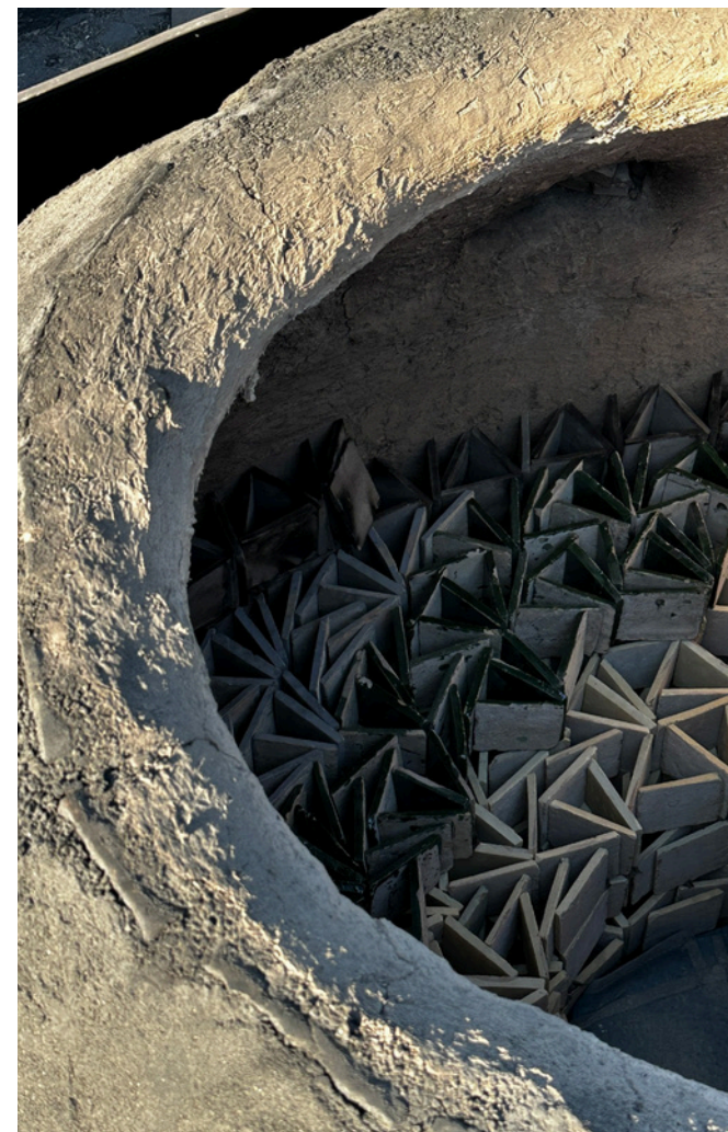
Carreaux de zellige dans le four de cuisson.
